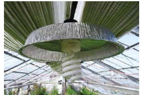
▲写真1 傘設置の様子 (半径28cmのアルミ皿)
